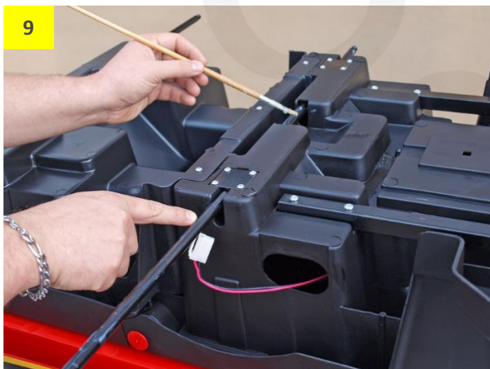
Obr. 11: Nasaďte motory na zadní osy ( R motory vpravo, L motory vlevo) a propojte konektory motorů.
