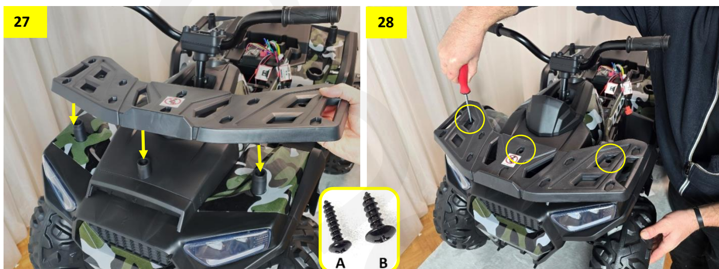
Obr. 29 a 30: Nasadte přední plastový rám. Rám srovnejte a přišroubujte (použijte 4 menší šroubky „A“).
