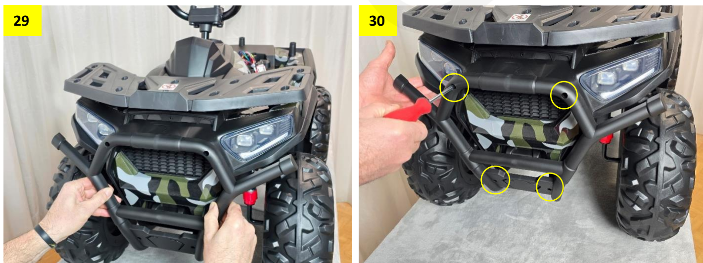
Obr. 29 a 30: Nasadte přední plastový rám. Rám srovnejte a přišroubujte (použijte 4 menší šroubky „A“).
