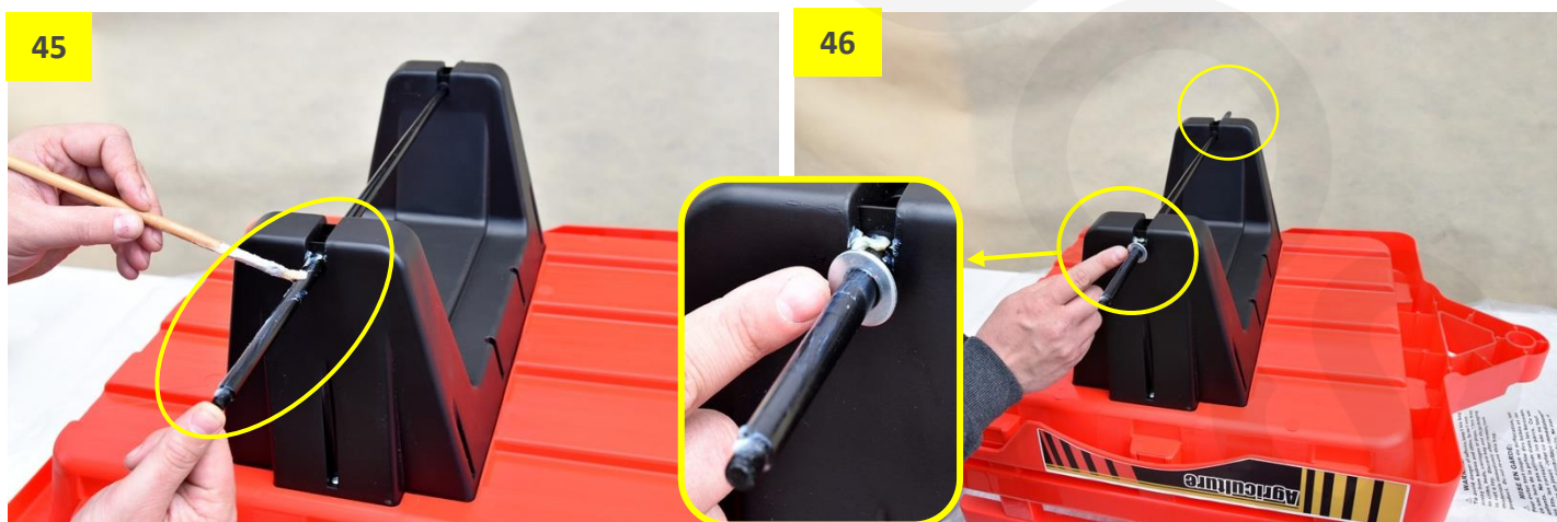
Obr. 46: Než nasadíte kola, je důležité nasadit nejdříve na levou i pravou stranu osy kovovou podložku.
